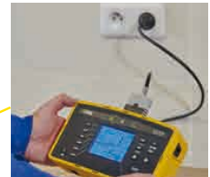
Dreiphasiges Netzkabel für Direktmessungen an 2 P + E Steckdosen
